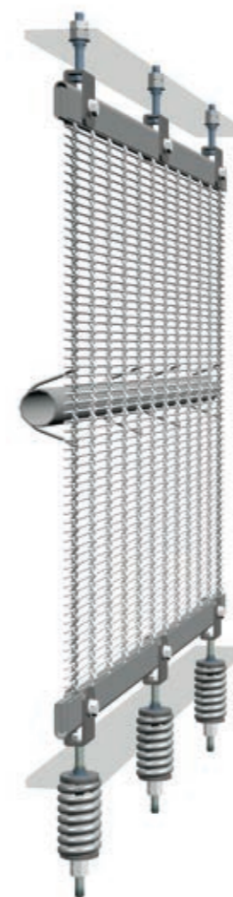
Befestigungstechnik für Fassaden aus Drahtgewebe.
